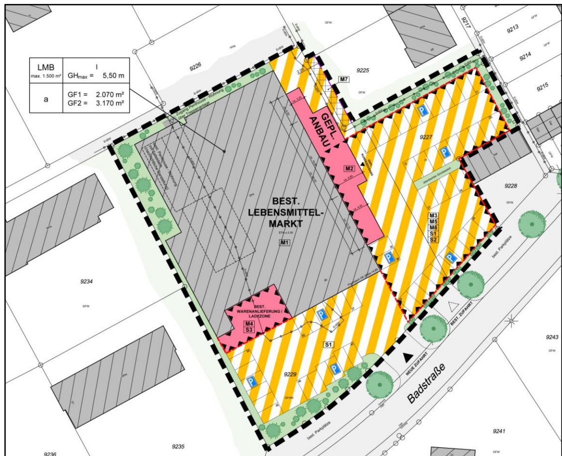
Bild 10: unmaßstäblicher Auszug aus der Planzeichnung (Teil A) mit Darstellung der Maßnahmen M1 – M7
